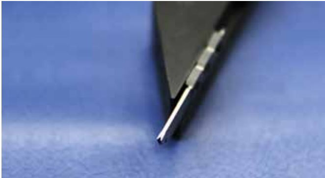
Werkzeug zum Abstechen dünnwandiger Teile
