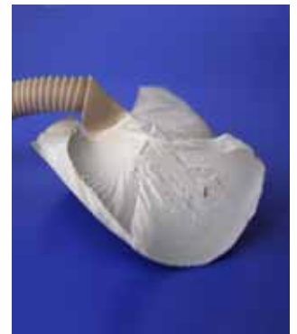
Geplatzttes Halbzeug aufgrund zu großer Spanabnahme
