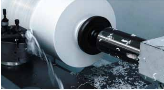
Fließspan beim Drehen
