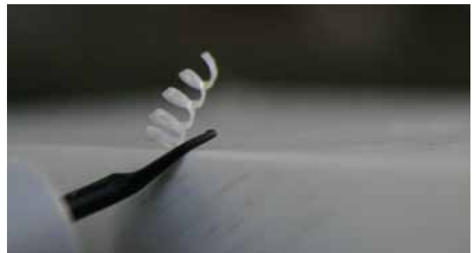
Entgratung mittels Entgratungsmesser
