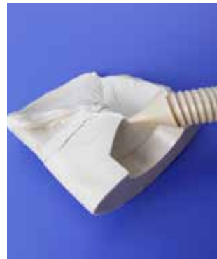
Geplatzttes Halbzeug aufgrund zu großer Spanabnahme
