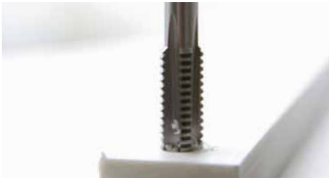
Gewindeherstellung mit Gewindebohrer
