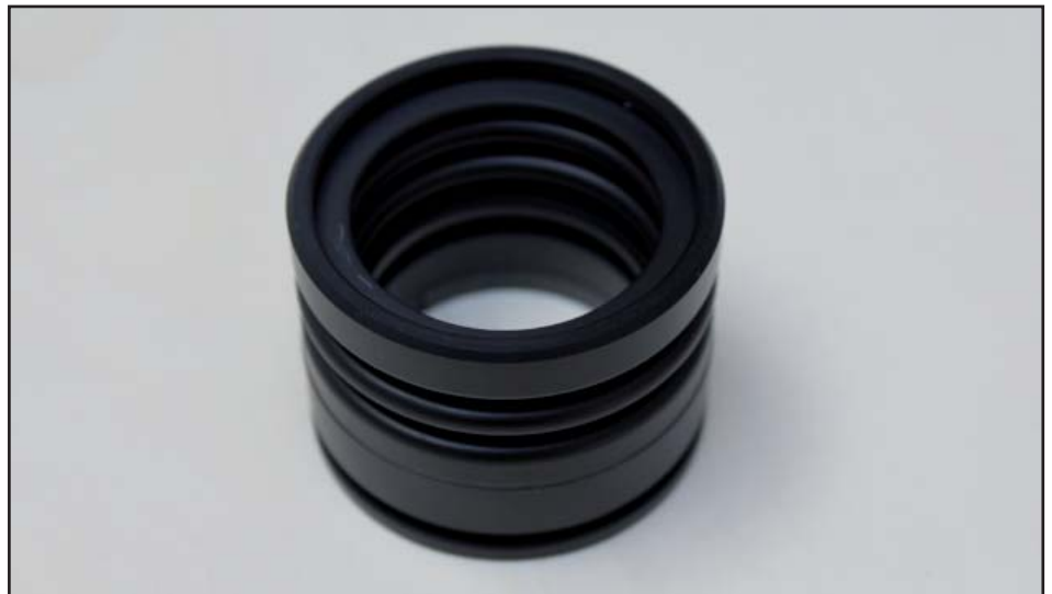
Bis 170°C dimensionsstabile Gleitringdichtung mit hoher Festigkeit, Verschleiß- und Schlagfestigkeit als Ersatz für PEEK natur.
